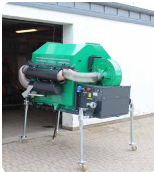
Abnehmbare, fahrbare Abstellstützen zum sicheren Abstellen
