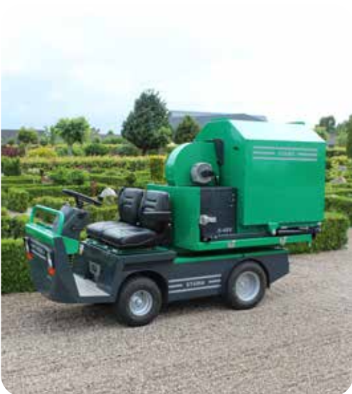
Ausführung mit vollelektrischer Saugereinheit
