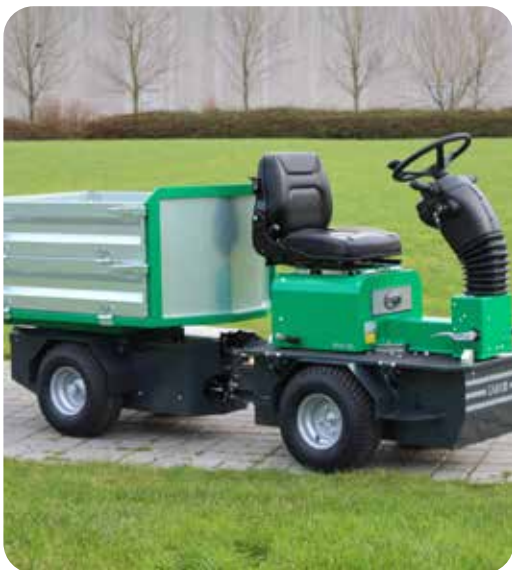
Wendbare Fahrerplattform für Ladepritsche vorne oder hinten
