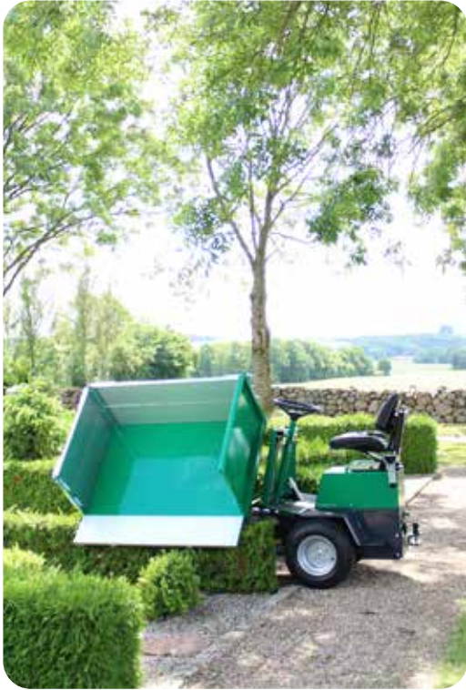
3-Seiten Kipper zum einfachen entladen
