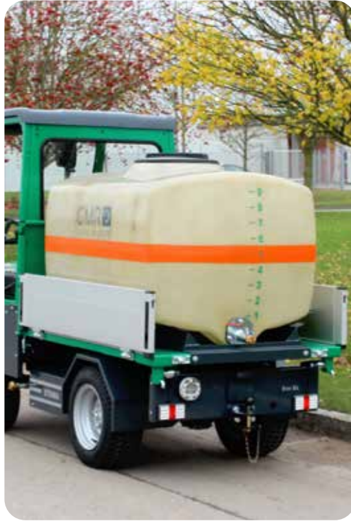
Mit aufgebauter Giessanlage und elektrischer Unterflurpumpe
