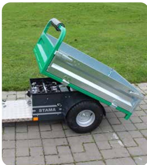
Kipper zum Entladen und Zugang zur Batterie
