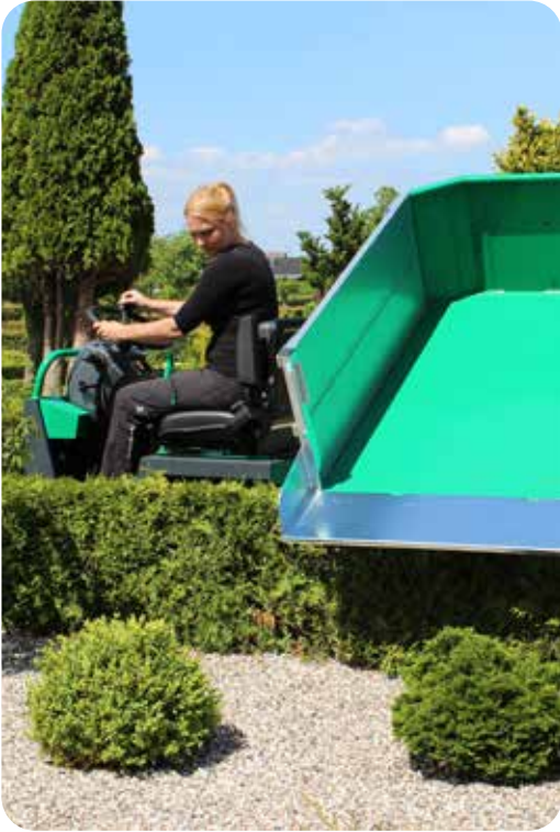
Hydraulische Kipppritsche und 180° schwenkbar
