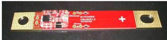
Le circuit imprimé est installé directement sur les pôles + et - de la cellule et a deux fonctions :
