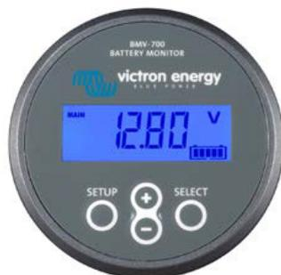
L'indicateur de batterie mesure le courant qui entre et qui sort de la batterie (comme un compteur électrique) et comptabilise l'énergie qui reste. L'indicateur est toujours connecté à la batterie, même si l'interrupteur principal est éteint.
