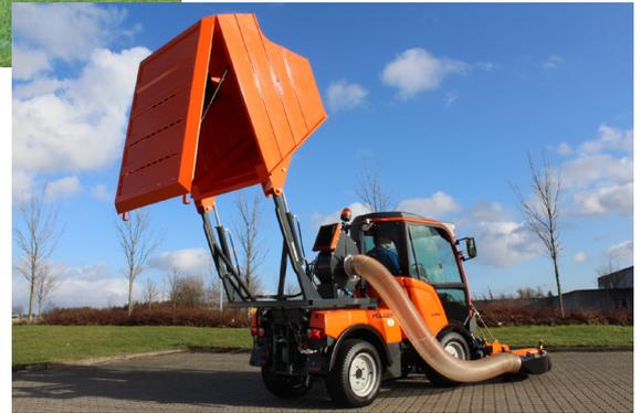
Cette faucheuse aspirante avec conteneur est conçue, en fonction de ses caractéristiques propres, pour l'aspiration de surfaces engazonnées en liaison avec le fauchage via une faucille frontale.
